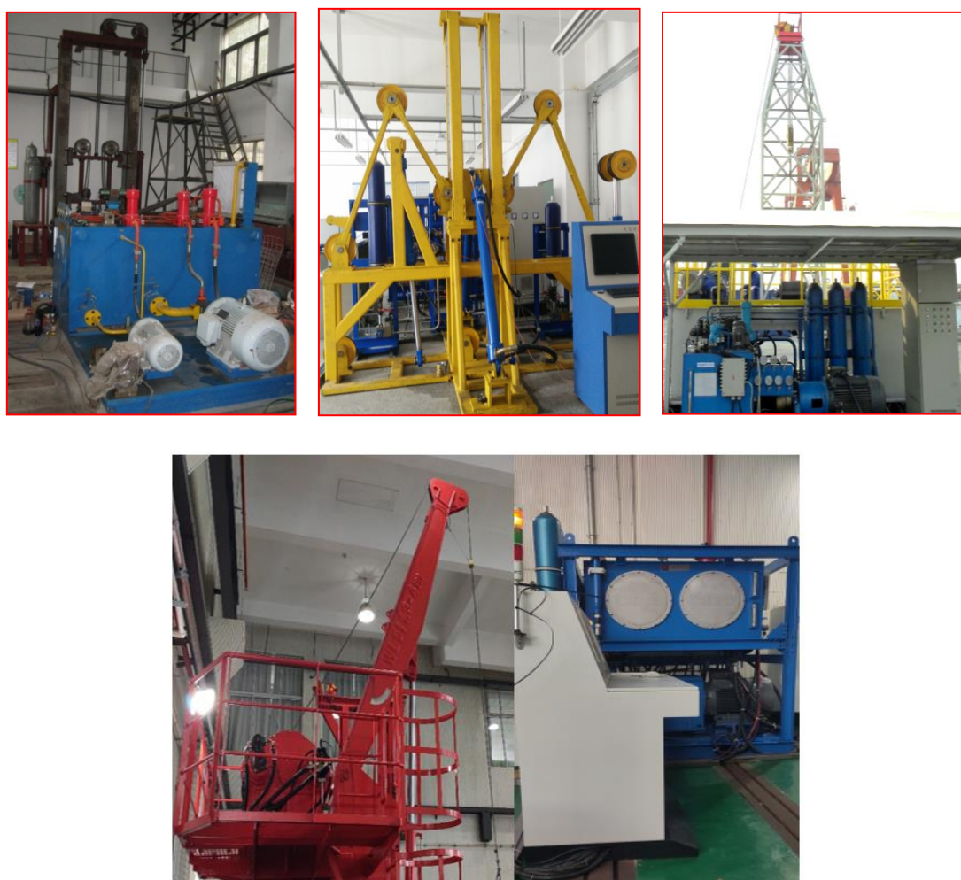
图 3 四种不同类型补偿系统的原理样机及其试验系统
