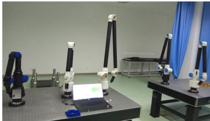
图 2 多型号便携式 6 自由度非正交坐标测量机
