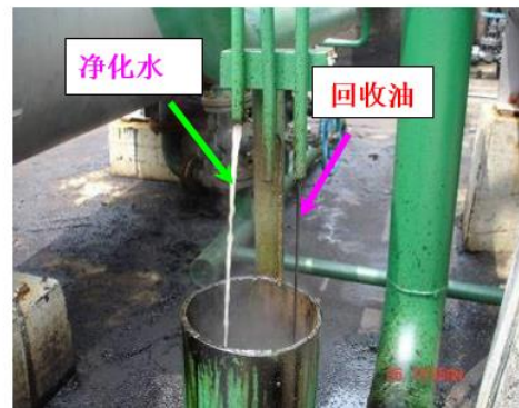
炼厂电脱盐装置污水在线处理（原油就地回收回炼）技术
