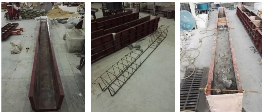
图2 再生大骨料自密实混凝土梁制备
