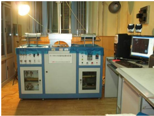
构造物理模拟实验装置
