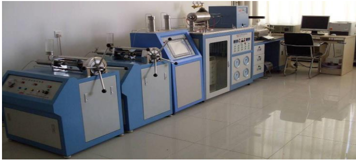
储层成岩模拟实验装置
