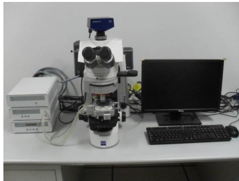
流体包裹体分析测试装置
